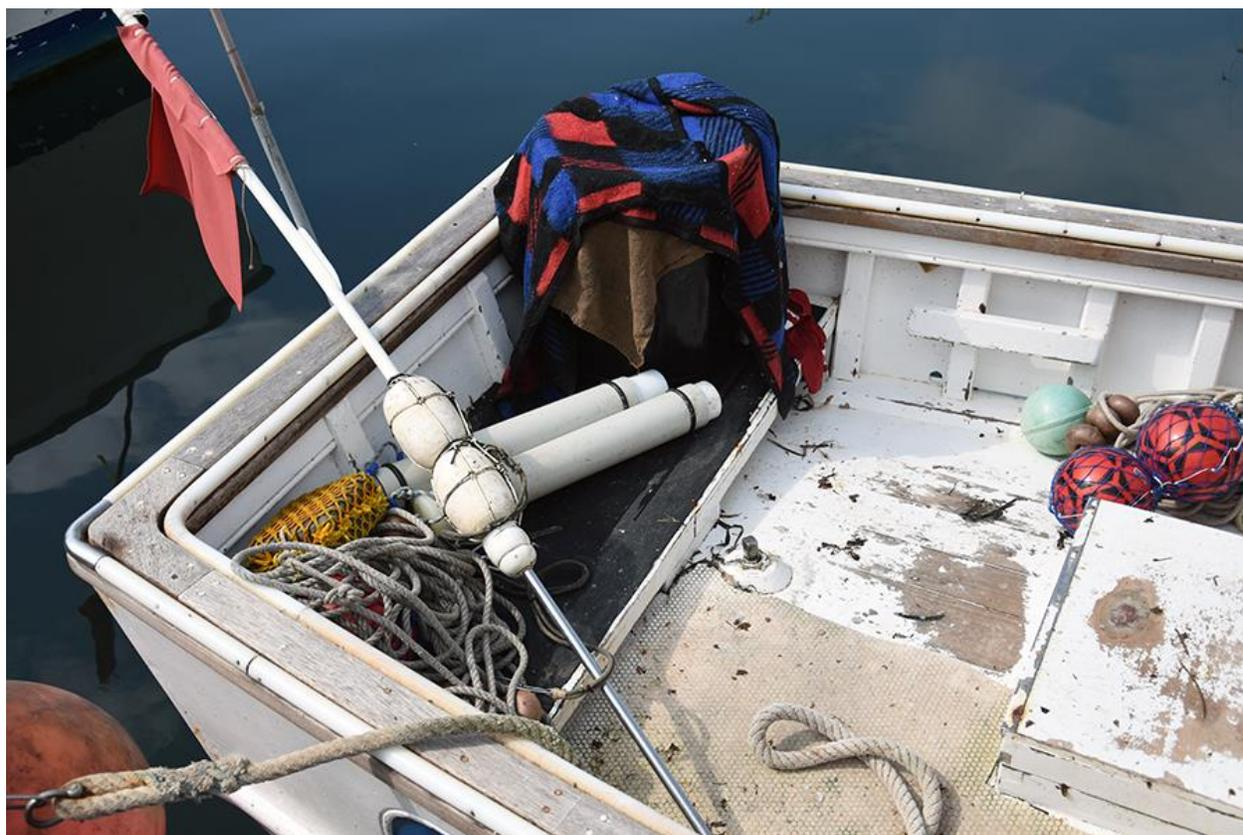
Figura 15. Un C-POD y un F-POD estibados en una embarcación pesquera junto a la baliza del aparejo de pesca al que se une.
