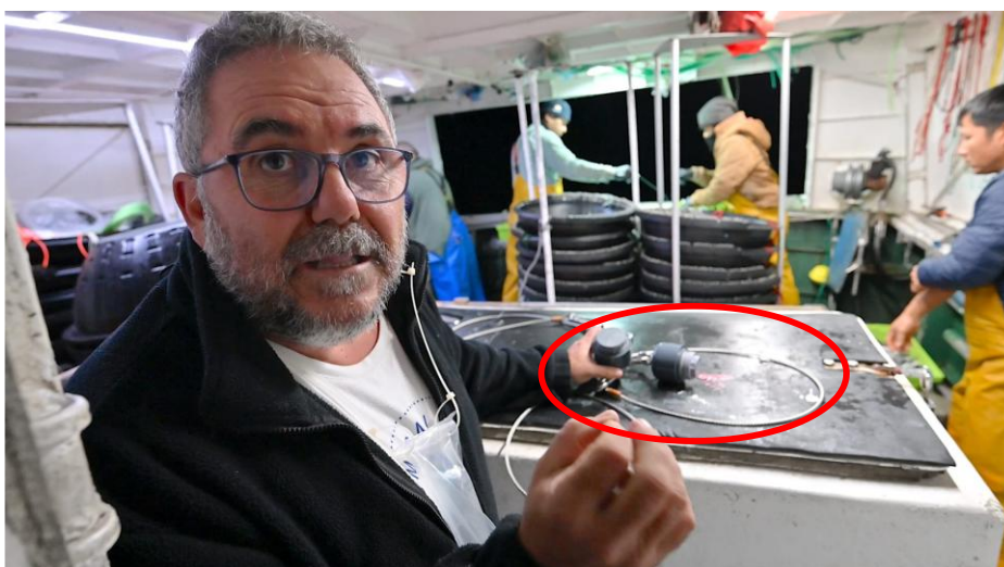
Foto 6. Dispositivos OGT ( Operational GPS Tracker ) (círculo rojo) que se engrilletaron en las boyas de inicio y final de cada aparejo
