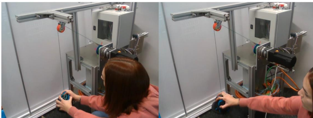
Ilustración 16. Personal ejerciendo fuerza sobre la pesa para validar el funcionamiento de la aplicación
