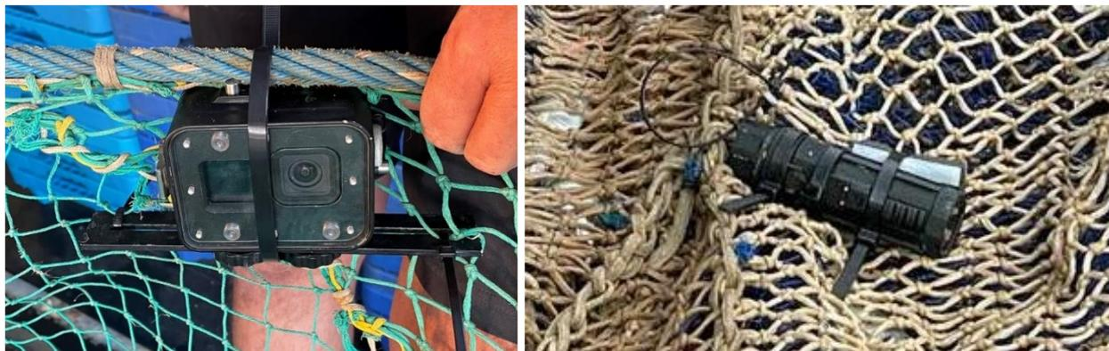
Figura 17 Cámaras colocadas en la red de pesca, en diferentes posiciones. Izquierda: Gopro Hero 10 en carcasa T-Housing en el lateral interno de la red. Derecha: Paralenz Vaquita colocada en el exterior de copo de la red.
