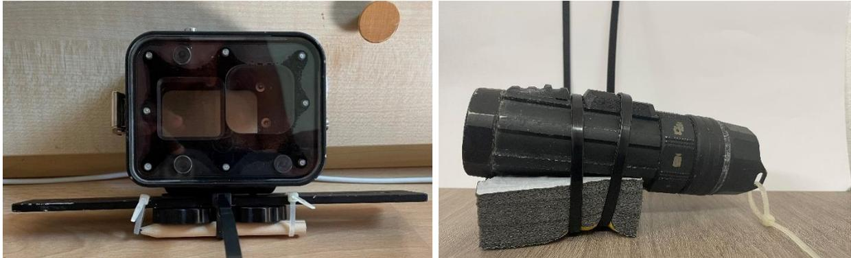
Figura 16 Izquierda: Carcasa T-Housing para GoPro Hero 10 montada sobre una pletina y elevada con un cilindro de madera. Derecha: Cámara Paralenz Vaquita con espuma para elevar la parte anterior de la cámara y ganar ángulo. La brida colocada en el anillo de la cámara se coge a la red como brida de seguridad, si por la presión se escapa la espuma la cámara queda libre de la red solo cogida por esta brida de seguridad.
