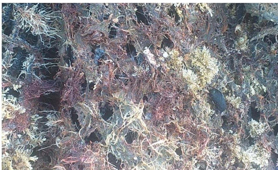
Figura 10: Red completamente obstruida por biofouling. (Fuente: Empresa anónima).
