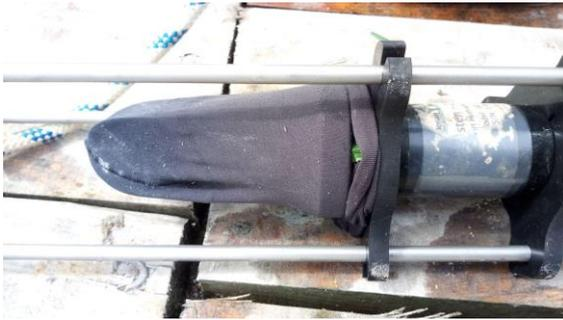
Fig. 7: pantalla anti-flujo instalada sobre el hidrófono
