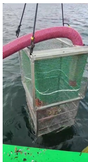
Figura 4.1. Prototipo de jaula rígida modular MAJA-J01 en acero galvanizado (izquierda, muelle de Boiro) e izado de la jaula completa con malacate desde la batea (derecha).
