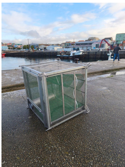
Figura 4.1. Prototipo de jaula rígida modular MAJA-J01 en acero galvanizado (izquierda, muelle de Boiro) e izado de la jaula completa con malacate desde la batea (derecha).
