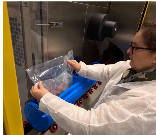
Imagen 16: Izquierda: Equipo de Altas Presiones Hidrostáticas Hiperbaric H55, disponible en la Planta Piloto de ANFACO-CYTM. Derecha: Vasija conteniendo una bolsa con una muestra de centollo juvenil
