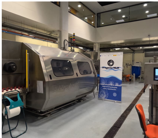
Imagen 16: Izquierda: Equipo de Altas Presiones Hidrostáticas Hiperbaric H55, disponible en la Planta Piloto de ANFACO-CYTM. Derecha: Vasija conteniendo una bolsa con una muestra de centollo juvenil
