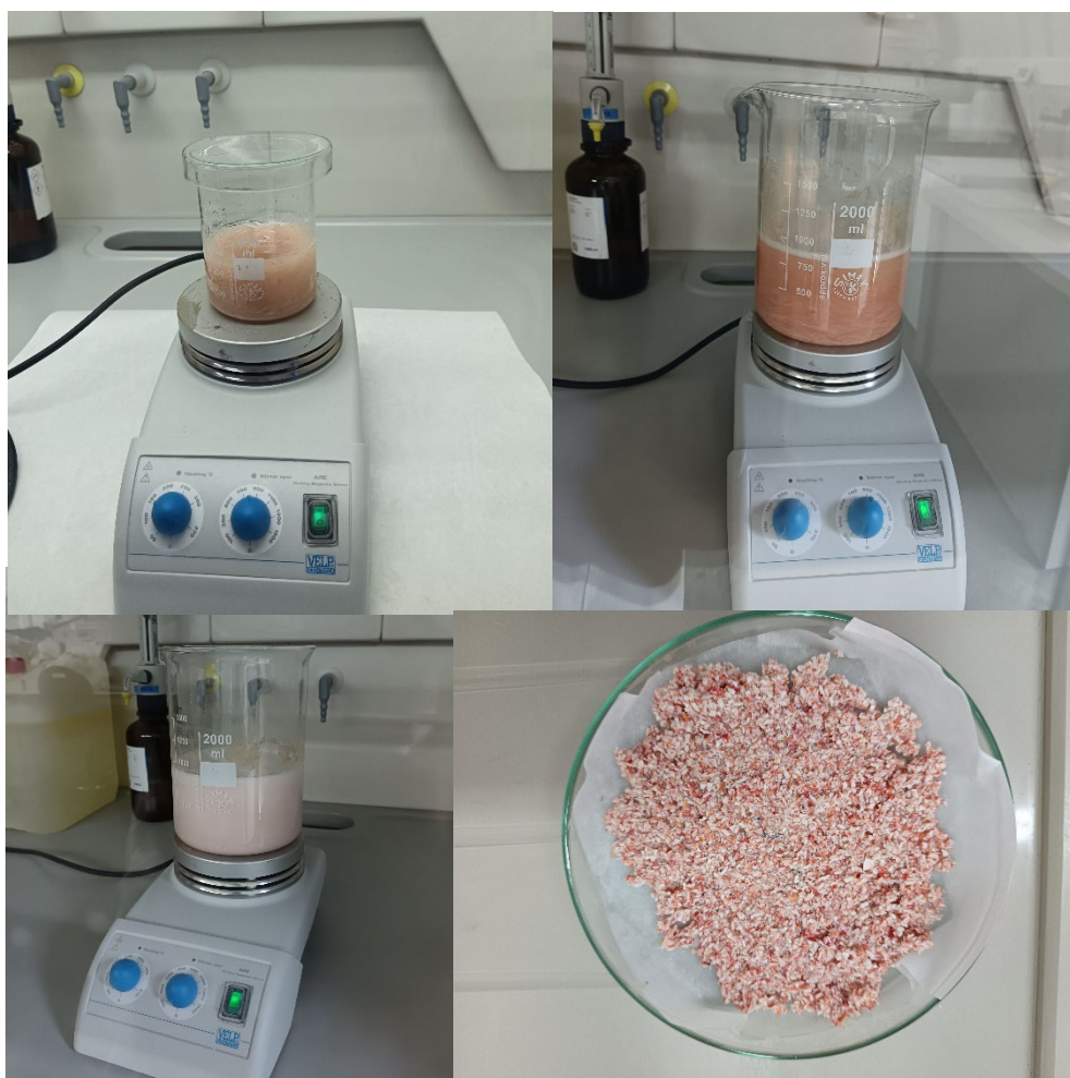
Fig. 1.- A) proceso de desproteínización de la conchilla de caparazón. B) Proceso de desmineralización. C) Proceso de decoloración. D) Quitina obtenida al finalizar la extracción.
