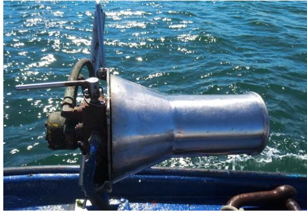
Imagen 4. Cabestrante del halador térmico del barco medido en Cortegada
