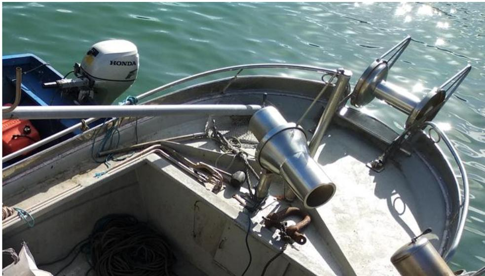
Imagen 2. Cabestrante del halador del barco medido en A Guarda
