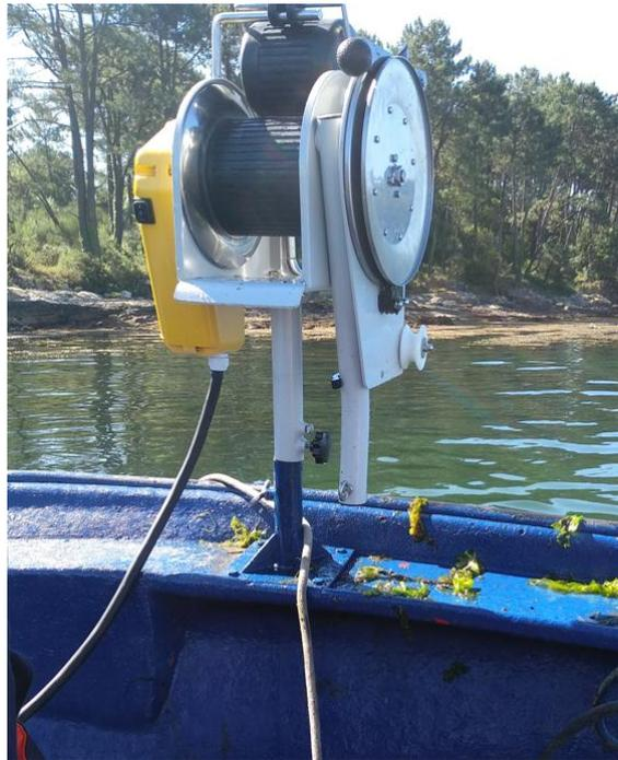
Imagen 6. Halador eléctrico instalado en el barco de Cortegada
